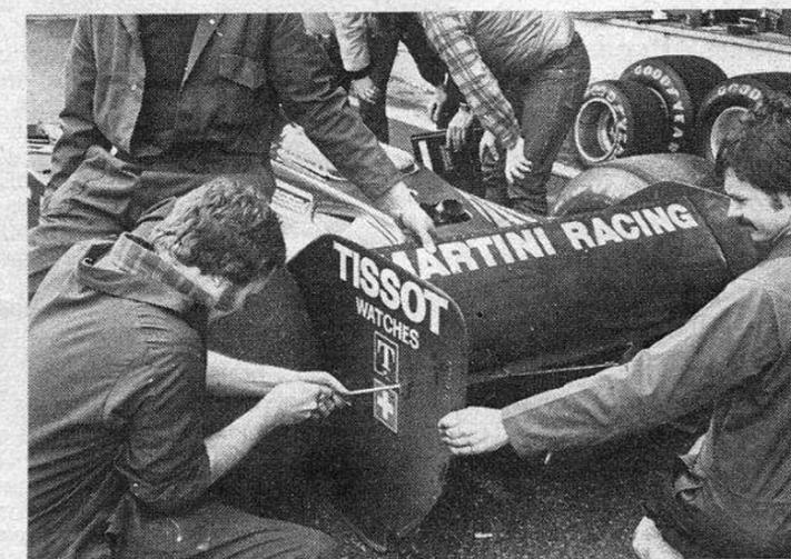
In alto, un'interessante vista della Lotus 80 priva delle ruote posteriori, con la « finestra » per le escursioni delle sospensioni. Qui sopra, si provvede a qualche foro supplementare per regolare l'incidenza dell'alettone posteriore (foto AGOSTI)
