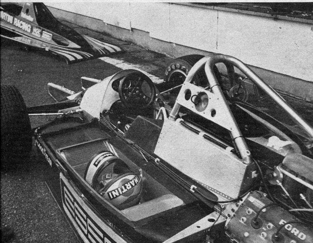
A sinistra, la posizione dei radiatori e le uscite d'aria. Si noti il roll-bar principale in tubi. A destra, la struttura anteriore per le minigonne che sono state per ora eliminate
